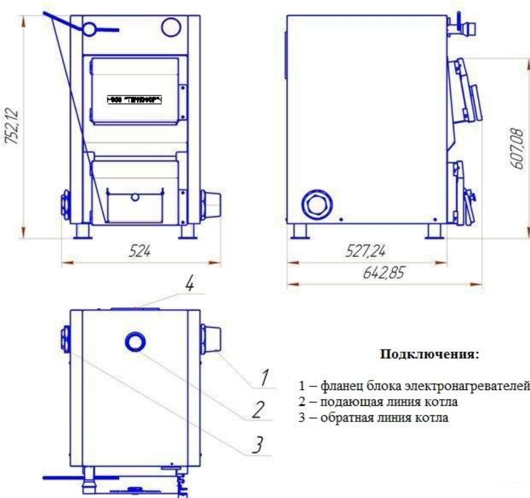
Рисунок 3 Размеры и подключения
