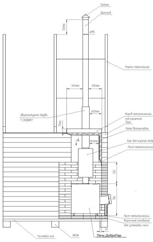
*В целях пожарной безопасности и регулирования газодинамического процесса в работающей печи рекомендуется установка шибера в канал дымохода, в доступном для эксплуатации месте.*
