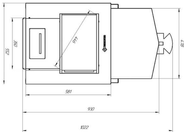
Габаритные размеры печи «Паровоз 14-18 Плазма»
