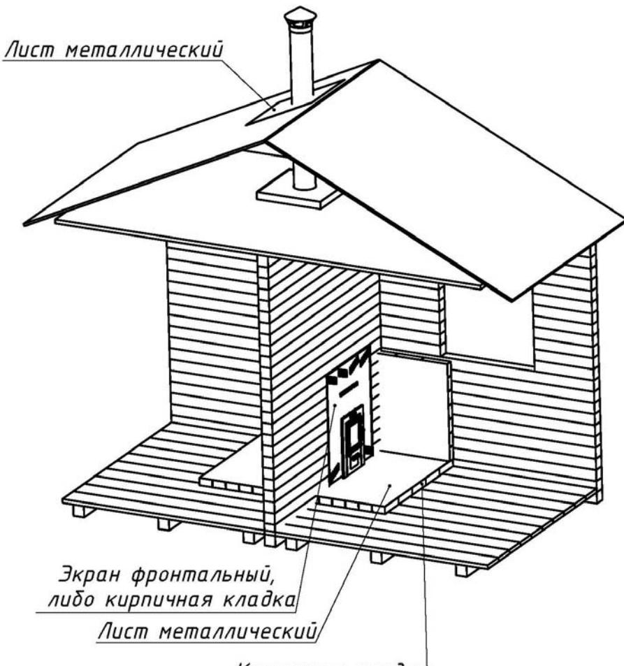
Рисунок 2 – Схема монтажа печи (вид с предбанника)
