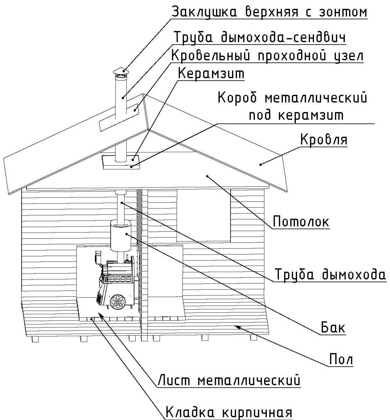
Рисунок 2а – Схема монтажа печи (общий вид)
