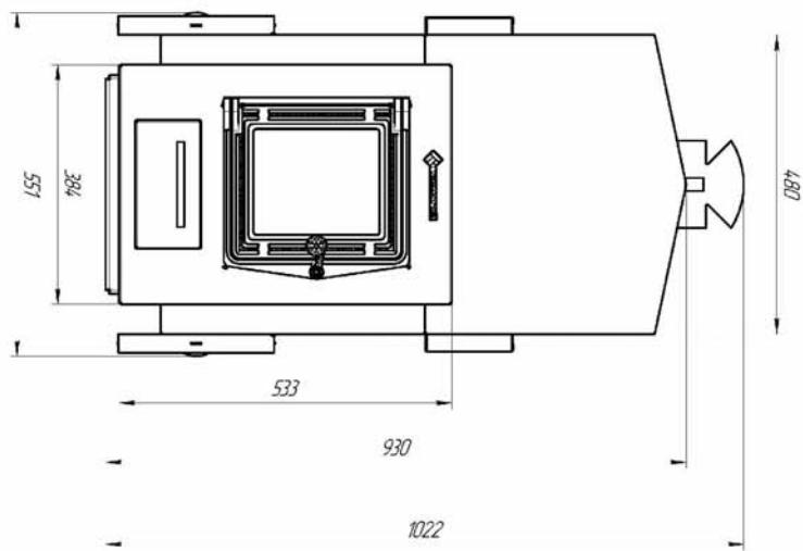
Габаритные размеры печи «Паровоз 14-18» (чугунная дверца)
