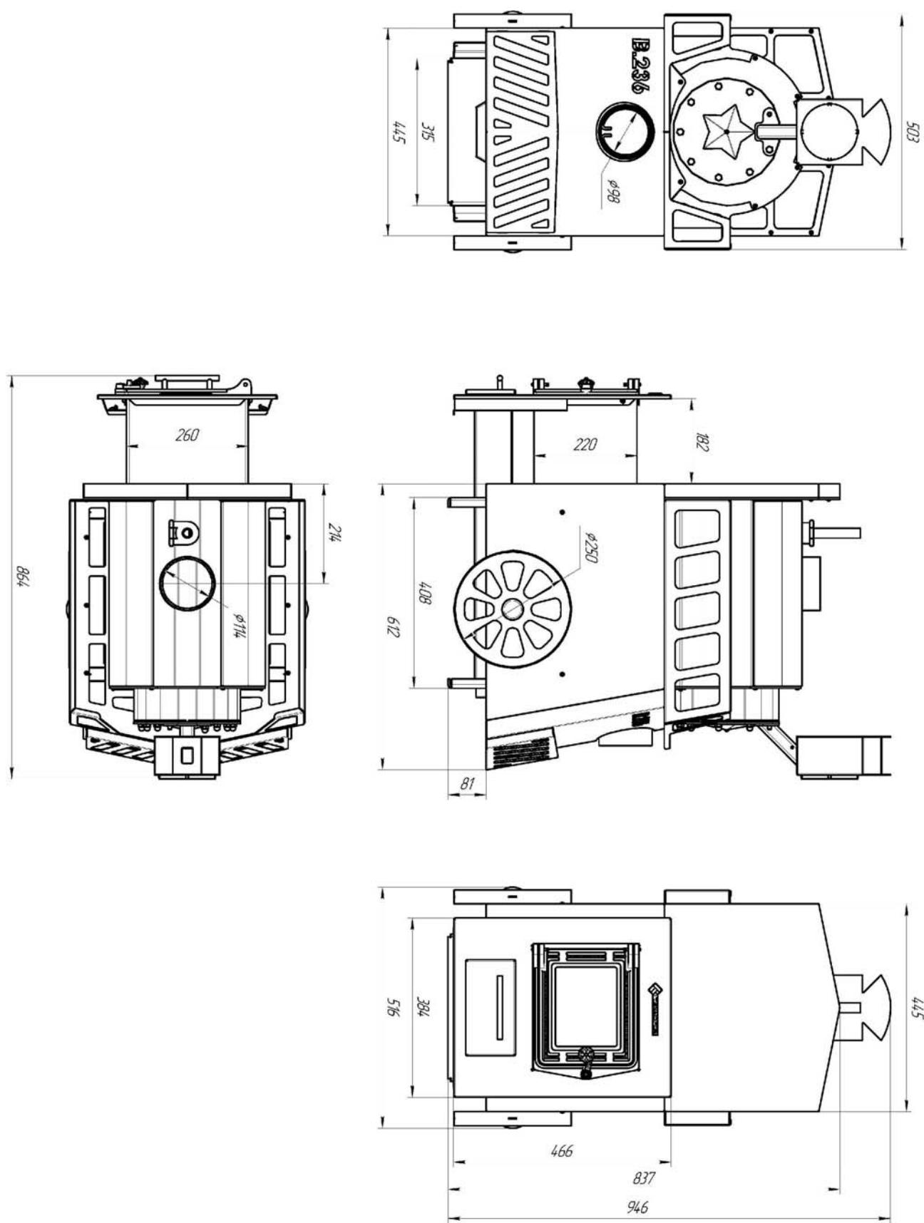
Габаритные размеры печи «Паровоз 9-14» (чугунная дверца)
