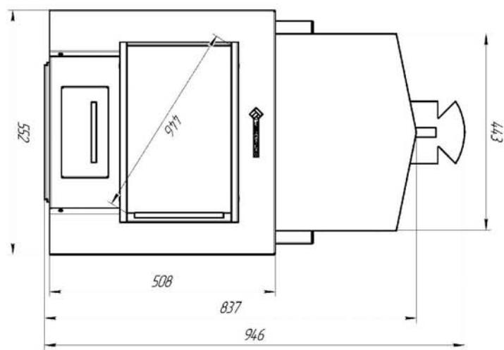
Габаритные размеры печи «Паровоз 9-14 Плазма»
